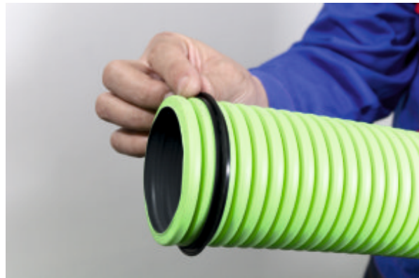
2) Do 2. nebo 3. drážky nasadíme těsnící kroužek.
